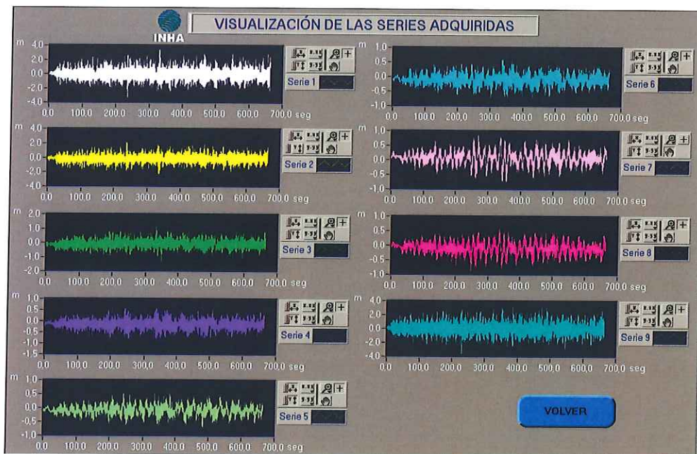
Figura 3: Representación gráfica de las series de superficie libre adquiridas durante la realización de los ensayos
