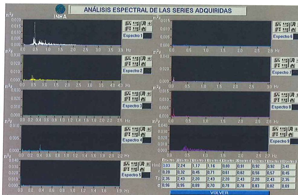
Figura 4: Representación gráfica de los espectros de las series de superficie libre adquiridas durante la realización de los ensayos
